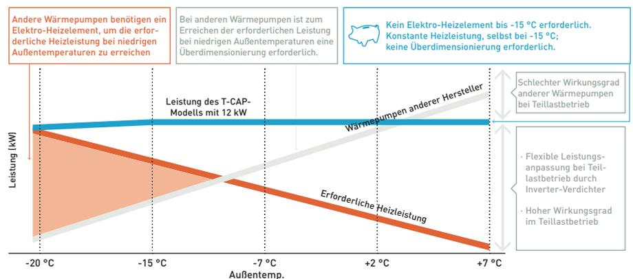
\* Bei 55 °C Wasservorlauftemperatur. Bei 35 °C Wasservorlauftemperatur bleibt die Heizleistung bis -20 °C Außentemperatur konstant.
